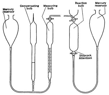
FIGURE 68. Du Pont Nitrometer.
